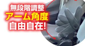
NV200バネットのフロントシート専用開発された無段階式アームレストが新登場。アームレストの肘の置くアーム角度を好みに合わせて無段階で調整ができる仕様となっております。長時間のドライブにも役立つサポートアイテムです。取付けはシートの表皮をめくり、ウレタンをカットしボルトナットで固定します。
