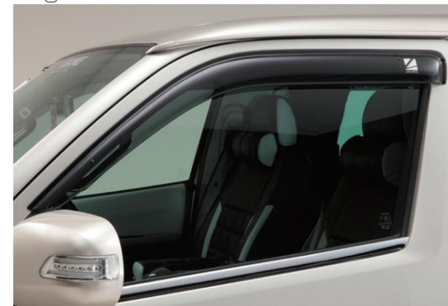
幅8.6cmのスリムタイプ、取付も純正と同じく両面テープとフックで完全固定。
