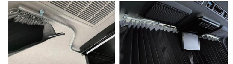
フリップダウンモニターをかわして間仕切りカーテンを付けることができるレールが登場。ワイドスーパーロング用・ワイドミドルルーフ用・ナロー標準ボディ用をご用意。ワイドスーパーロングとワイドミドル共に最大12.8インチ、ナローは10.2インチまでのフリップダウンモニターに接触しないように、かわして取付けいただけます。
