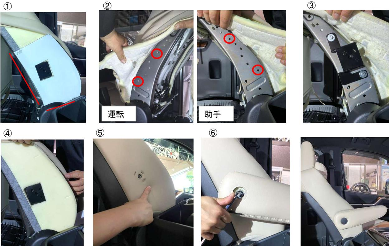
**!** アームレスト本体は、**ステーにボルトでしっかり固定**してから動作確認をしてください。
