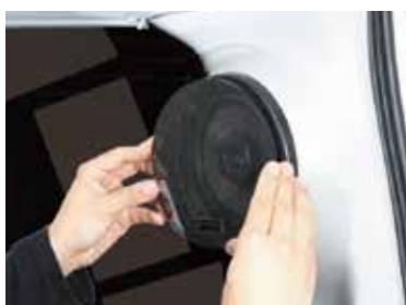
スピーカーリングの溝にグリルを嵌め込む。
