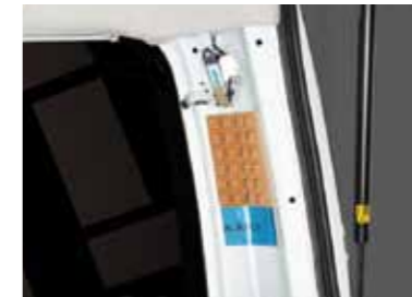
レアルシルトの上に横2列並べて貼り付けます。 ※貼る前に曲面に合わせてデフュージョンを馴染ませてください。
