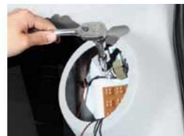
取り外したボルトを使って、アンテナカプラーブラケットとDピラーカバーを一緒に固定します。
