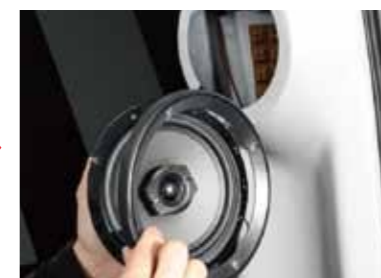
スピーカーにリングを被せる。
