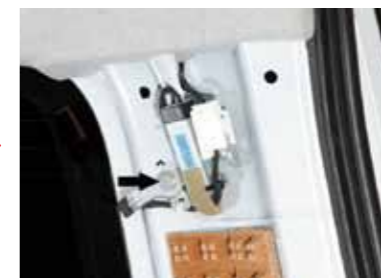
取り外したボルトはDピラーカバーの固定に使います。
